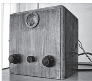
Механический телевизор «Б-2», 30-е годы XX века.
